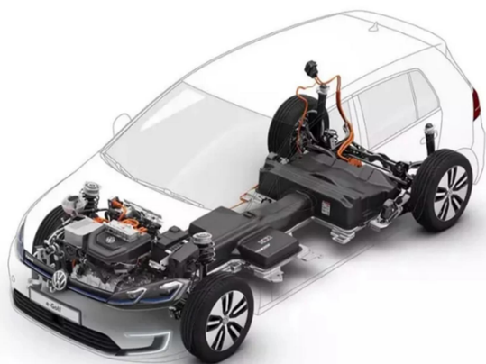
图表 4：油改电平台（大众 MQB 燃油平台改 e-Golf）
