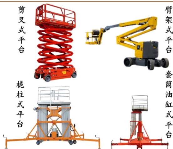
图 10：常见的高空作业平台设备类型
