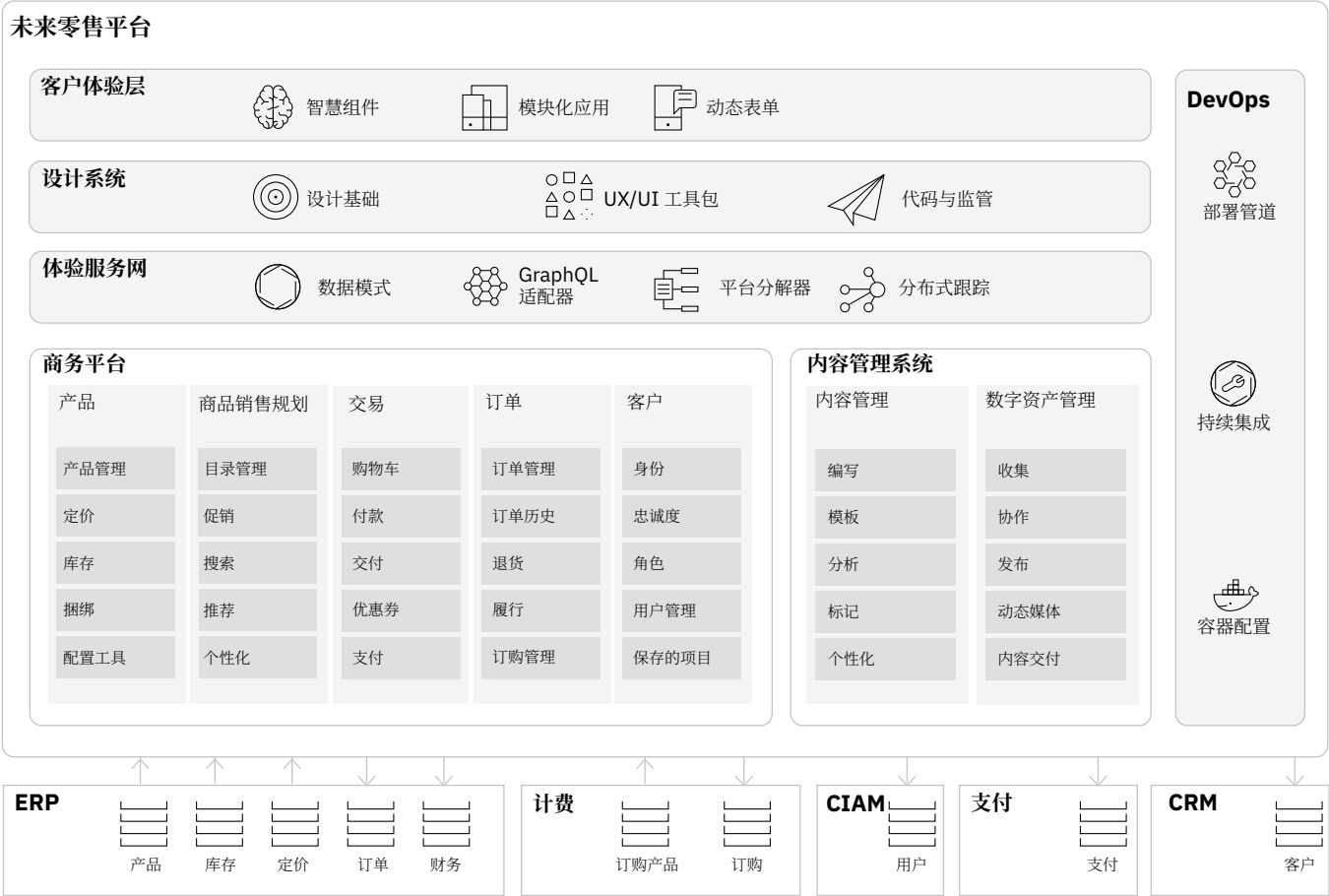
图 2 “无头”架构支持 OEM 开发灵活的模块化客户体验层
