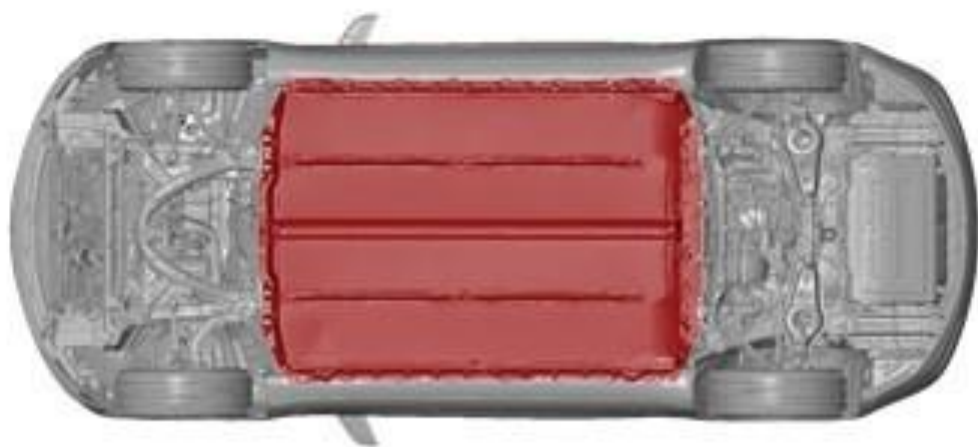
原生电动汽车 电池组架构（示例）
